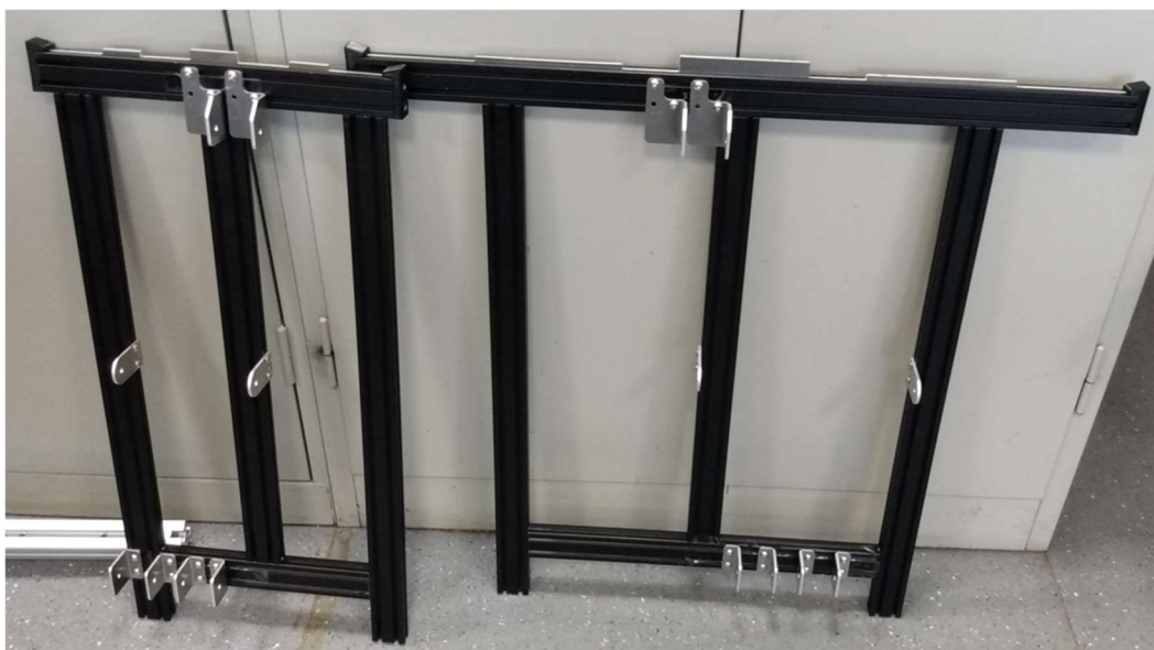
Abb. 14 Vormontage rechter Seitenrahmen
